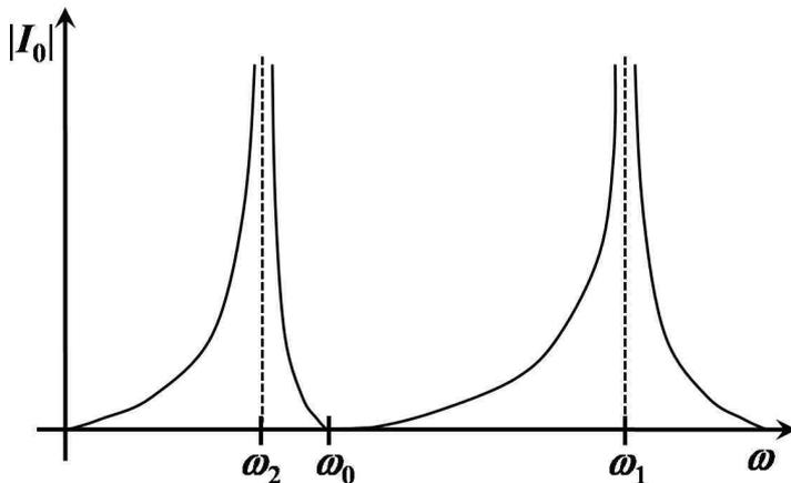
Punto 3): Il circuito a destra è costituito dall'impedenza  $Z_1$  fatta da  $C_1$  e  $L_1$  in serie, e dall'impedenza  $Z_2$  fatta da  $C_2$  e  $L_2$  in parallelo; a loro volta  $Z_1$  e  $Z_2$  sono questa volta in parallelo. Le impedenze  $Z_1$  e  $Z_2$  sono le stesse determinate al punto 1):
