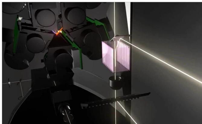
✓ **STELLARIS 5 DEMO è dotata di Sistema di detection spettrale basato su Prisma**
